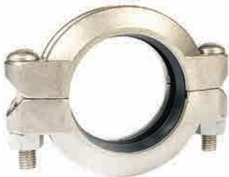
L'accouplement rigide Figure 472 GRINNELL est en acier inoxydable 316L et peut supporter une pression maximale atteignant 41,4 bar (600 psi), selon le matériau et/ou l'épaisseur de la paroi du tuyau.
