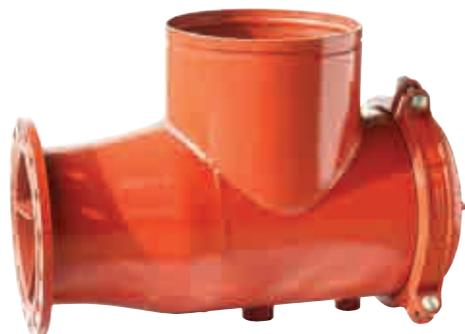
Le Diffuseur d'aspiration modèle 725G se caractérise par une conception gain de place, un corps en fer ductile et des aubes intégrales qui réduisent efficacement les tourbillons et assurent des conditions de débit optimales sur le côté admission de la pompe.
