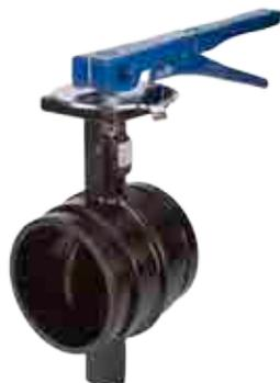
La vanne papillon modèle B303 de 50 à 200 mm (2" à 8") à levier de commande a un papillon qui offre des positions d'étranglement tous les 10° pour la régulation manuelle en équilibrage jusqu'à 90° ou à l'arrêt du service. Le levier peut être verrouillé dans n'importe laquelle des positions, y compris en position ouverte ou fermée, au moyen d'un orifice de verrouillage qui se trouve dans la poignée et le levier.
