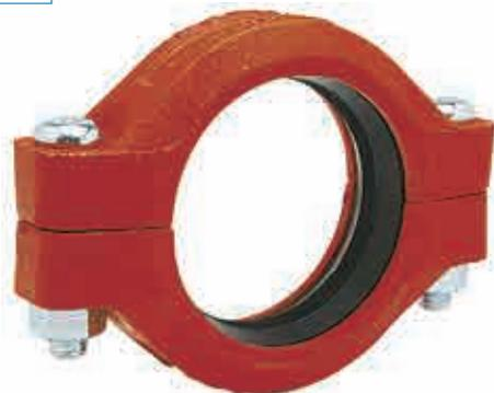
L'accouplement flexible usage intensif GRINNELL Figure 707 autorise la déflexion angulaire et linéaire, la dilatation thermique et la contraction, et les défauts d'alignement des tuyaux. Les accouplements flexibles peuvent servir de « joint de dilatation », ce qui autorise un mouvement linéaire et angulaire des tuyaux lorsqu'ils sont installés correctement. Cet accouplement peut supporter les pressions jusqu'à 68,9 bar (1,000 psi), selon la dimension du tuyau et l'épaisseur de la paroi.
