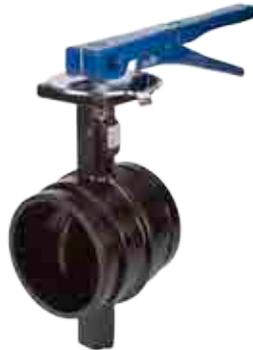
La válvula de mariposa Modelo B303 de 50 a 200 mm (2" a 8") con accionamiento de palanca de bloqueo tiene una placa de regulación que incluye muescas de regulación cada 10° para el control manual desde 90° o para cerrar el servicio. La palanca se puede ser bloquear con un candado en cualquiera de las posiciones, incluidas las posiciones abierta y cerrada, gracias a un orificio de bloqueo situado en el mango y la palanca.
