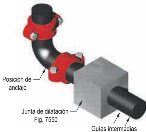
(2) Diseñar el sistema con acoplamientos flexibles y/o rígidos para permitir que la tubería se desplace en la dirección deseada, utilizando anclas y guías si se requiere. Con este método, es importante asegurarse de que el movimiento que se produzca en las derivaciones, cambios de dirección, puntos de conexión de equipos, etc., no provoque tensiones ni daños excesivos.
