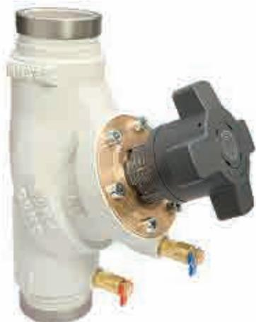
Las válvulas de compensación de GRINNELL Modelo CB800 permiten lograr un equilibrado preciso y eficiente de sistemas hidráulicos de calefacción o refrigeración. La válvula GRINNELL Modelo CB800 ranura a ranura, disponible en los tamaños de 65 a 300 mm (2 1/2" a 12"), está fabricada en hierro fundido.
