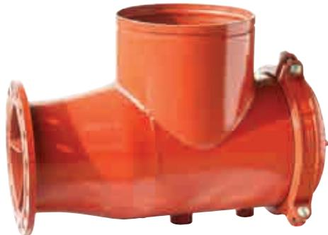
El difusor de succión Modelo 725G cuenta con un diseño que ahorra espacio, cuerpo de hierro dúctil y álabes integrales que efectivamente reducen la turbulencia y proporcionan óptimas condiciones de flujo en el lado de entrada de la bomba.
