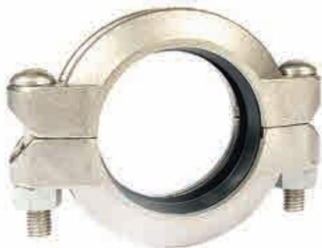
El acoplamiento rígido GRINNELL Figura 472 está fabricado con acero inoxidable 316L y es capaz de soportar presiones de hasta 41.4 Bar (600 psi).
