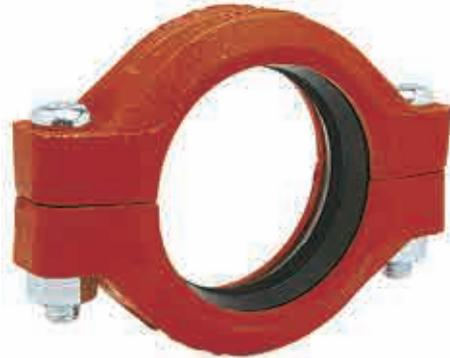
El acoplamiento flexible de alta exigencia GRINNELL Figura 707 permite una desviación lineal y angular, una contracción y expansión térmica y desalineación de la tubería. Los acoplamiento flexible puede actuar como una "junta de dilatación" al permitir el movimiento lineal y angular de los tubos cuando se instalan correctamente. Este acoplamiento puede resistir presiones de hasta 68.9 Bar (1000 psi), según el espesor de la pared y tamaño de la tubería.
