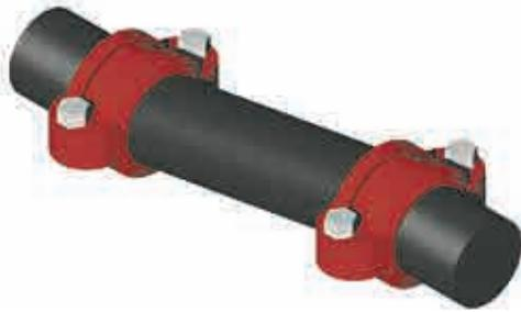
Si se desea absorber tanto la desviación como el movimiento lineal, el sistema deberá disponer de suficientes uniones flexibles para este requisito.
