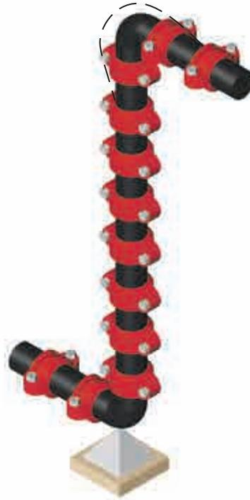
Al utilizar acoplamientos flexibles, hay que tener en consideración el movimiento lineal en los tramos de tubería largos. Cada unión puede deslizarse hasta la máxima separación entre extremos indicada. Este movimiento puede ser acumulativo y dar lugar al crecimiento de la red de tubería, por ejemplo en la parte alta de la misma. Puede hacer falta instalar desvíos.
