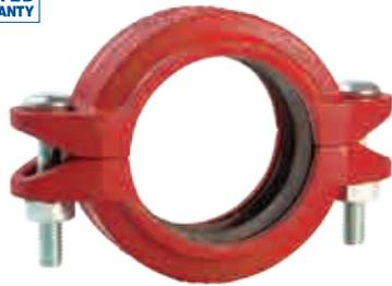
El acoplamiento rígido ranurado GRINNELL Figura 774 garantiza una unión rígida, sujetando firmemente las ranuras de la tubería a lo largo de toda su circunferencia. Los acoplamientos rígidos ranurados Figura 774 ofrecen un método fiable y comprobado para unir tuberías y son una alternativa económica a la soldadura, las rosas o el empleo de bridas. Puede resistir presiones de hasta 34,5 bar (500 psi) según el espesor de la pared y tamaño de la tubería.
