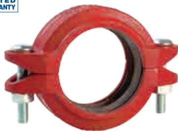
Il giunto rigido scanalato GRINNELL modello 774 fornisce un collegamento rigido fissandosi saldamente attorno all'intera circonferenza delle scanalature del tubo. I giunti rigidi scanalati modello 774 offrono un metodo sicuro e collaudato per unire le tubazioni e rappresentano un'alternativa economica alla saldatura, ai filetti o all'uso di flange. Resistono a pressioni fino a 34,5 bar (500 psi) in base al diametro e allo spessore dei tubi.
