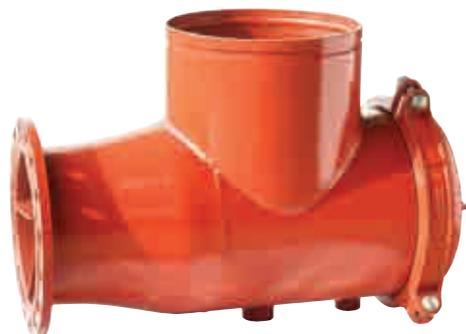
Il diffusore di aspirazione modello 725G presenta una costruzione compatta con corpo in ghisa sferoidale e palette integrate, studiata per ridurre efficacemente la turbolenza e creare condizioni di flusso ottimali sul lato di ingresso della pompa.
