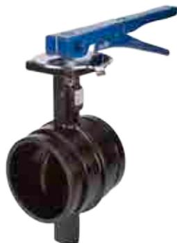
La valvola a farfalla modello B303 da 50 a 200 mm (da 2" a 8") con azionamento a leva presenta una piastra di regolazione dentellata con distanza tra gli incavi di 10° che consente un comando manuale per servizi di bilanciamento fino a 90° o servizi di arresto. La leva può essere bloccata in una qualsiasi delle posizioni disponibili, incluse le posizioni aperta e chiusa, attraverso un foro di bloccaggio situato nella maniglia e nella leva.
