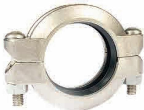
Il giunto rigido GRINNELL modello 472 è realizzato in acciaio inox 316 fuso e resiste a pressioni fino a 41,4 bar (600 psi).
