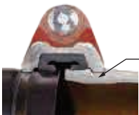
Contacto completo entre la chaveta del acoplamiento de la Figura 772 y el diámetro de la ranura
