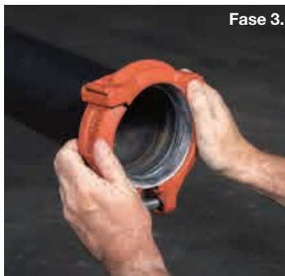
**Fase 3.** Spingere la guarnizione/il giunto all'interno di un'estremità del tubo sino a che l'arresto centrale della guarnizione si trova a contatto con l'estremità del tubo (vedere la figura 2).
