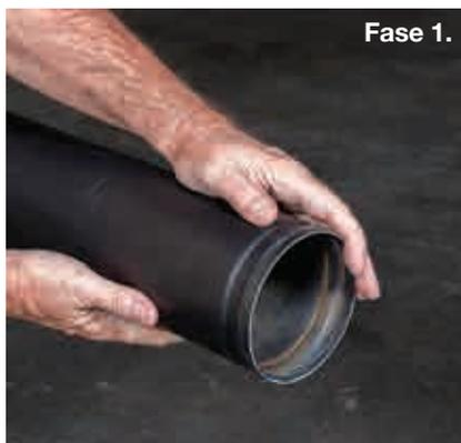
**Fase 1.** Ispezionare la scanalatura esterna e le estremità della tubazione per verificare che siano prive di bave, residui sciolti, particelle di sporco, trucioli, vernice e altro materiale estraneo. Le superfici di tenuta delle estremità della tubazione devono essere prive di spigoli acuti, sporgenze, rientranze e/o altri difetti.
