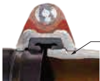
Voller Kontakt zwischen Kupplungspassfeder Figur 772 und Nutgrund
