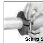
**Schritt 5:** Die Schrauben in die Kupplung einsetzen und die Muttern fingerfest anziehen. Sicherstellen, dass die Schraubenköpfe einwandfrei in der Aussparung des Gehäuses versenkt sind.
